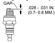
Figure 28. Spark Plug Gap
